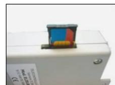
*Примечание: для проверки правильности программирования SIM карты включите устройство (после установки SIM карты и подключения антенны), подождите минуту, нажмите кнопку для ручной коммутации выхода.*
